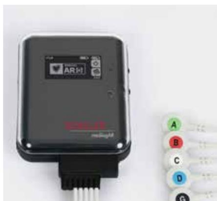
medilogAR: Leicht, einfach zu reinigen, verfügbar mit 5- oder 7-adrigem Patienten-kabel
